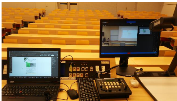
写真3. 大学1号館地下シアター教室に設置されている固定型収録機器 左：授業用PC（プロジェクタで投影して利用）、右：収録機操作画面
